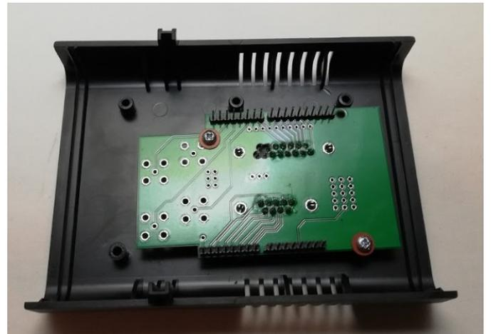
*Bild 2: Gehäuse mit eingeschraubtem Shield*
