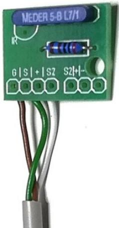
Der Sensor besteht aus einer kleinen Platine mit aufgelötetem Reedsensor (blau) und Widerstand. Der Reedsensor muss für eine optimale Fahrzeufferfassung möglichst mittig und dicht unter der Fahrbahnoberfläche platziert werden. Somit kann dieser gut von unten neben den Bahnschlitz angebracht werden.
