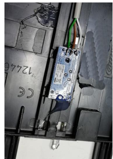
Montage des Sensors in der Schiene.
