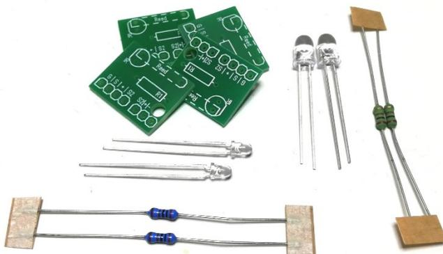
Einzelteile des IR-Sensors für 2 Spuren
