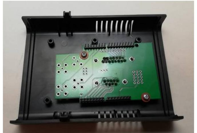
*Bild 2: Gehäuse mit eingeschraubtem Shield*
