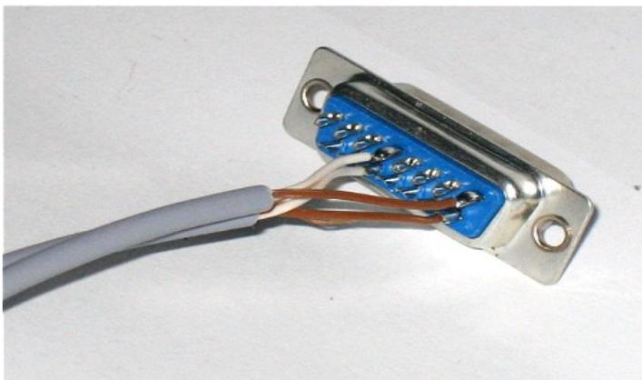
Das Kabel für Sensor 1 wird an Pin 1 (Sensorsignal) und Pin 5 (+5 Volt) angelötet,
