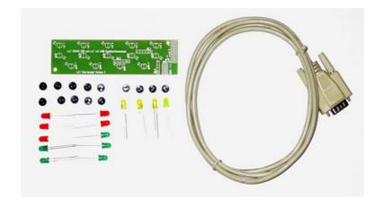
Optional ist Anschlussmaterial für die L&T IOW40 USB-Boardversionen 0001 bis 0002 enthalten. Dieses kann auch für Boardversionen 0003 ohne vorbereitetet Ampelsteckplatz genutzt werden.
